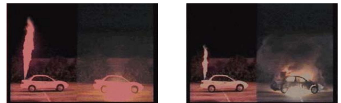
Figuur 15: Vergelijking van een brand met waterstof (wagen links) en benzine (wagen rechts). Foto links: 3 seconden na ontsteking; foto rechts: 60 seconden na ontsteking (Bron: Swain, 2001).
